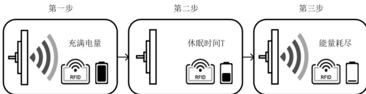
图 2. RFID 电量指纹获取过程
