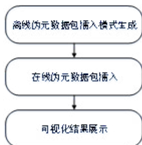
图 3-1 在线 Web 站点指纹防御系统工作流程
